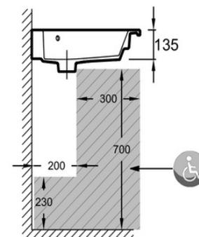
Descriptif CCTP : Plan-vasque 100 cm, non meulé. EXAU112. Collection : ODÉON RIVE GAUCHE. DIMENSIONS : 101 x 51,20 cm. POIDS : 28,4 kg. MATÉRIAU : Céramique. TYPE D'INSTALLATION : Autoportant.
