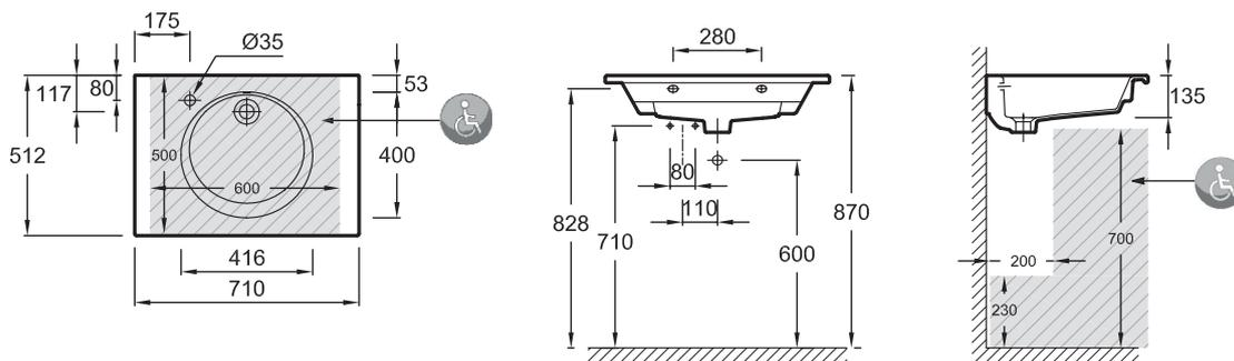
Descriptif CCTP : Plan-vasque 71 cm, meulé. EXAX112-Z. Collection : ODÉON RIVE GAUCHE. DIMENSIONS : 71 x 51,20 cm. POIDS : 21,6 kg. MATÉRIAU : Céramique. TYPE D'INSTALLATION : Autoportant ou peut être monté sur un meuble spécifique.
