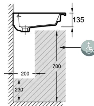
Descriptif CCTP : Plan-vasque 71 cm, non meulé. EXAX112. Collection : ODÉON RIVE GAUCHE. DIMENSIONS : 71 x 51,20 cm. POIDS : 21,6 kg. MATÉRIAU : Céramique. TYPE D'INSTALLATION : Autoportant. DURÉE GARANTIE (ANNÉES) : 10.
