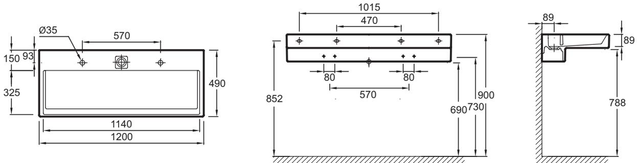
Descriptif CCTP : Plan-vasque 120 cm, bandeau LED. EXB9112. Collection : TERRACE. DIMENSIONS : 120 x 49 cm. POIDS : 37,2 kg. MATÉRIAU : Céramique. TYPE D'INSTALLATION : Autoportant ou peut être monté sur un meuble spécifique. PERCEMENT ROBINETTERIE : 2 trous. CONFIGURATION : STANDARD. TROP-PLEIN : Avec. NOMBRE DE VASQUES : 1 cuve.
