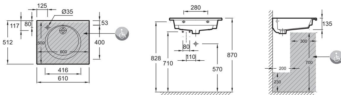
Descriptif CCTP : Plan-vasque 60 cm, meulé. EXBA112-Z. Collection : ODÉON RIVE GAUCHE. DIMENSIONS : 61 x 51,20 cm. POIDS : 17 kg. MATÉRIAU : Céramique. TYPE D'INSTALLATION : Autoportant.
