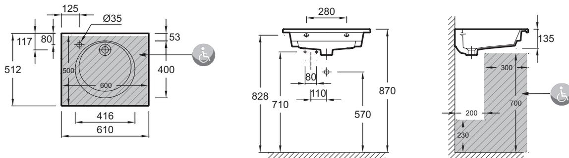
Descriptif CCTP : Plan-vasque 60 cm, non meulé. EXBA112. Collection : ODÉON RIVE GAUCHE. DIMENSIONS : 61 x 51,20 cm. POIDS : 17 kg. MATÉRIAU : Céramique. TYPE D'INSTALLATION : Autoportant.
