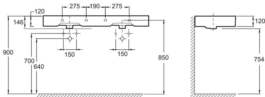
Descriptif CCTP : Double plan-vasque 121 cm. EXBL112. Collection : VIVIENNE. DIMENSIONS : 121,20 x 46,60 cm. POIDS : 30,7 kg. MATÉRIAU : Céramique. TYPE D'INSTALLATION : Autoportant ou peut être monté sur un meuble spécifique.
