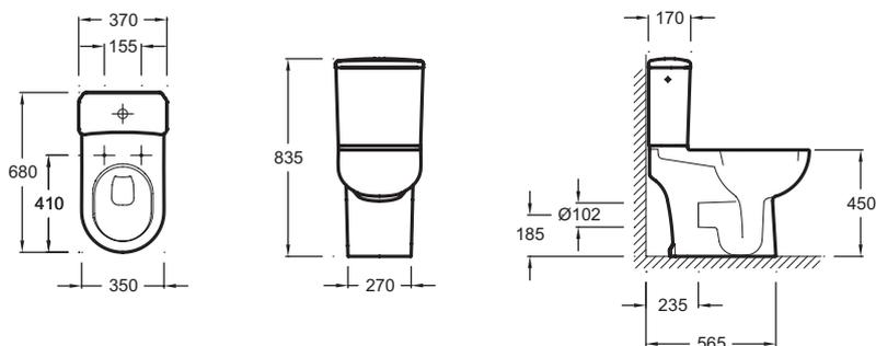
Descriptif CCTP : Cuvette au sol surélevée, sortie Vario NBTW. UJF111. Collection : ODÉON. DIMENSIONS : 68 x 35 cm. POIDS : 26,9 kg. MATÉRIAU : Céramique. TYPE D'INSTALLATION : Au sol. CONSOMMATION D'EAU : Standard 3/6 L. HAUTEUR : PMR. TYPE DE BRIDE : Ouverte (traditionnelle).
